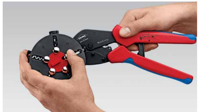
Crimpeinsatz-Wechsel: Magazinposition entsperren, Crimpeinsatz in der Zange entnehmen
