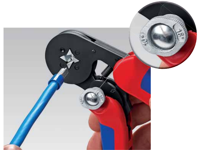
Das Wechseln der Crimpkapazität von 10 mm 2 auf 16 mm 2 erfolgt durch Umschalten
