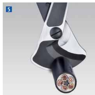
Schneid- und Öffnungsvorgang wiederholen, bis das Kabel durchgeschnitten ist
