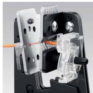
Formschlüssiges Abisolieren durch präzise Messerprofile
