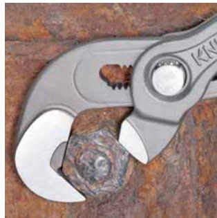
Arbeiten an verrosteter Mutter mit verrundeten Kanten
