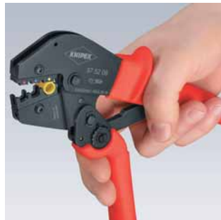
Erster Schritt: Heranholen des Schenkels mit zwei Fingern, bis beide Backen auf dem zu vercrimpenden Verbinder aufliegen
