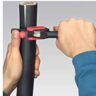
Drehen des Werkzeugs für Umfangsschnitt
