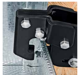
Das Stempelwerkzeug wird durch die Profilbleche gedrückt
