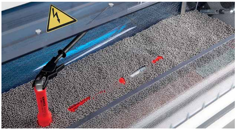
Prüfung der elektrischen Isoliereigenschaften.
