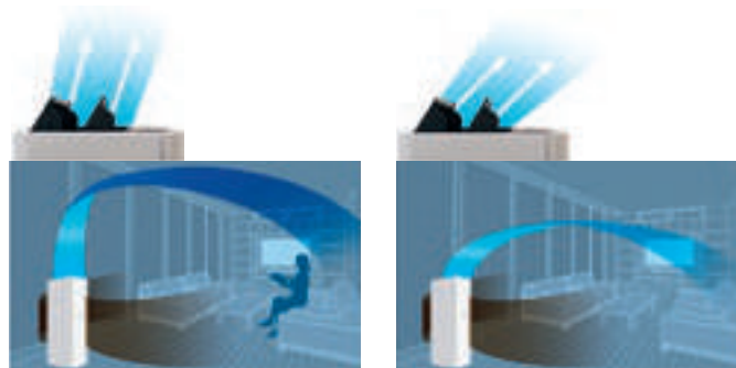
Der i-see Sensor ortet eine Person Der Luftstrom wird über den Kopf der Person hinweg geleitet.
