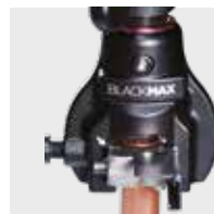
Exzentrischer Aufweitkonus für einfacheres Bördeln
