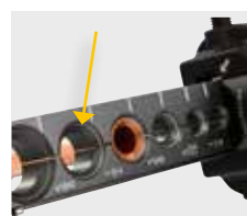
Lasergrafierte Sichtschablone zur Prüfung des Bördelflansches
