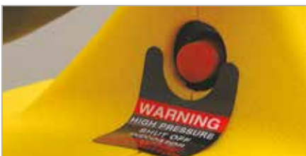
Anzeigeleuchte für Hochdruckabschaltung
