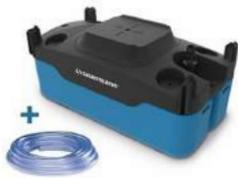
Die Si-83 Zentrifugalpumpe kann am Boden, an der Wand oder deckenhängend installiert werden und bietet 6 Möglichkeiten für den Anschluss der Kondensatleitung. Mit ihrem sehr flachen Profil kann Sie einfach unter den Geräten montiert werden: Höhe 129 mm.
