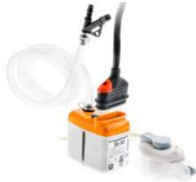
Die Si-30 mit getrenntem und transparentem Schwimmerschalter ist geeignet für Fan Coils, Decken- und Decken-Einbaugeräte, Wand-Split sowie Stand-Geräte. Der große Kolbendurchmesser kombiniert mit einem Kammfiltersystem anstelle feinmaschiger Filter garantiert die Förderung von großen Partikeln ohne Verstopfung und gewährleistet somit eine lange und reibungslose Betriebsdauer.
