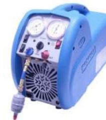
Tragbare Absaugstation von Bosch. Zum Absaugen von allen CFC, HFC, HCFC, Kältemitteln inkl. R410A und A2L Kältemittel wie z.B. R32 oder R1234yf. Luftgekühlter, ölfreier Verdichter. Hochdruckabschaltung bei 38,5 bar
