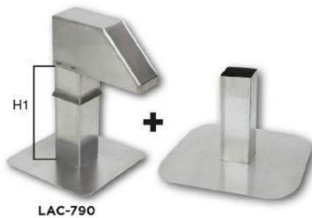
Aluminium Dachdurchführung zum wettergeschützten Durchführen von Rohrleitungen auf Flachdächern. Durch den Unterbau ist die Höhe einstellbar, je nach Isolationsdicke bis max. 300 mm.
