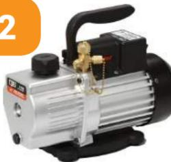
Diese zweistufige Vakuumpumpe ist die Premiümlösung zur Erzielung des tiefsten Endvakuum (10 Mikron). Die VPS6DEV mit ihren versiegelten Komponenten ist auch für die Verwendung an Ammoniak-Systemen geeignet. Die Vakuumpumpe besitzt außerdem ein Magnetventil. Für alle Kältemittel der Klasse A1, A2L und A3 (Vorsichtsmaßnahmen berücksichtigen) geeignet.
