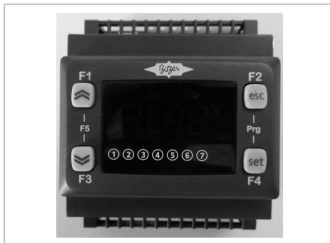
Fig. 14: Interface utilisateur du régulateur ECOLITE
