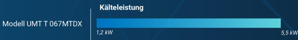
**Kälteleistung bei t<sub>0</sub> = -10°C**
