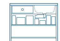
Waschbeckenmöbel mit horizontal installierter Geruchsverschluss
