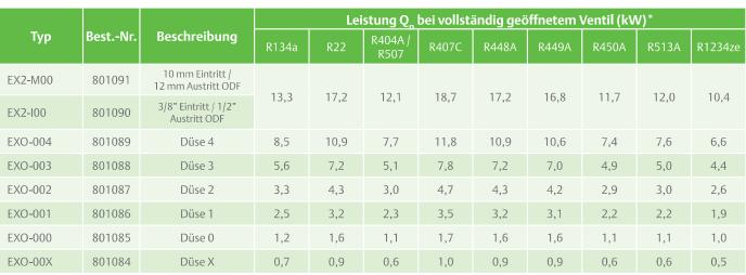
Hinweis 1: \*) Düseneinsatz zur Abdeckung von Lastschwankungen bis max. 80% von Qn wahlen.
