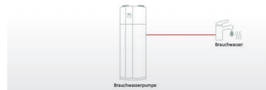
Variante 3: Wärmepumpe für Warmwasserbereitung
