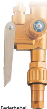
Federhebel zur Steuerung des Schneidsauerstoffs
