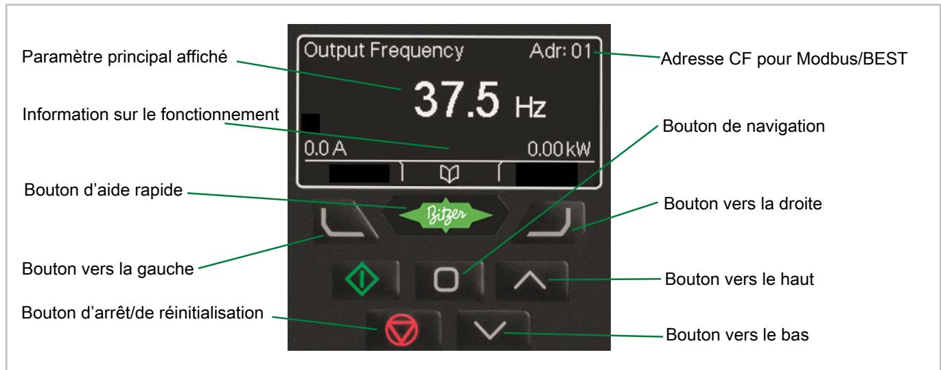
**Affichage du paramètre principal** : ce champ affiche le paramètre actuellement sélectionné, par exemple la fréquence du moteur, le courant du moteur, etc.
