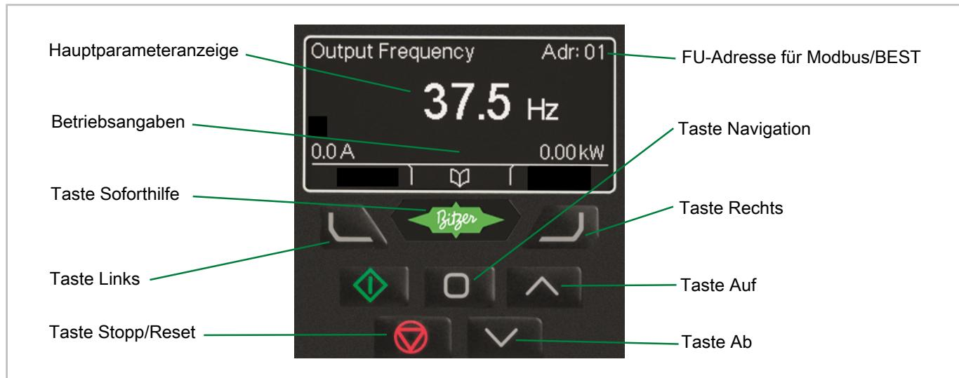
**Hauptparameteranzeige:** Hier wird der aktuell ausgewählte Parameter angezeigt, z. B. Motorfrequenz, Motorstrom usw.
