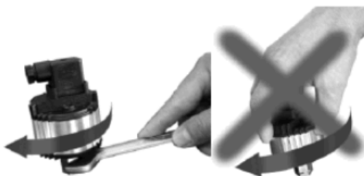
Abbildung 3: Sollwerteneinstellung mittels Einstellschraube
