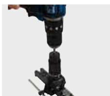
Noch schnelleres Bördeln durch Verwendung mit Akkubohrer
