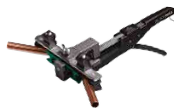
Konfiguration für Rückwärtsbiegung (Hervorragend für beengte Platzverhältnisse)
