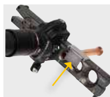
Verschiebbarer Tiefenanschlag setzt das Rohr auf die genaue Höhe
